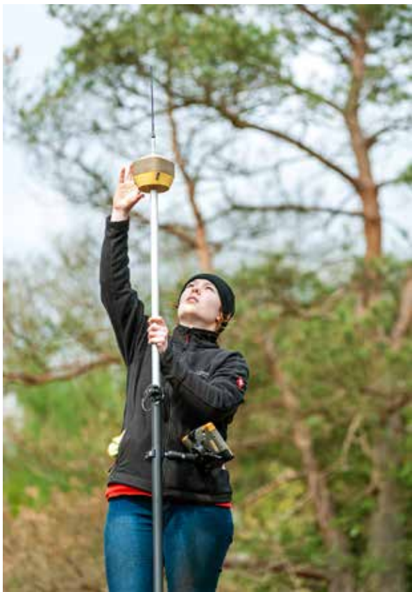
Mit einem GPS-Base-Rover-System können Funde und Abbaublöcke sehr genau eingemessen werden
